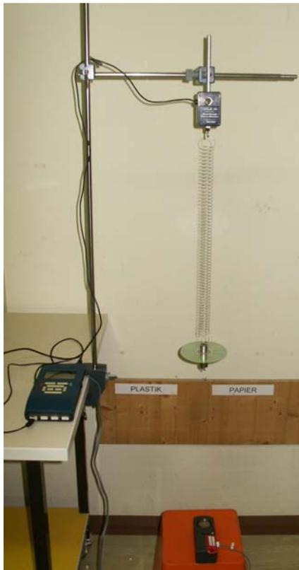
An einer Feder hängt ein Masse (z.B. 50g + 50g), die in Schwingung versetzt wird; **von unten** wird die Bewegung mit dem **Ultraschall-Detektor** aufgezeichnet. Damit der Sensor das kleine Massenstück trifft, hängen wir auch noch eine CD (z.B. an das Massenstück geklebt) oder einen kreisrunden Karton dazu.
