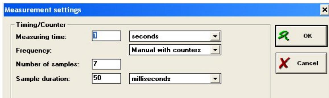
Wir können so **7 Datensätze** (jeweils Volumen und Druck) aufnehmen. Bevor wir aber mit der Aufnahme der Daten beginnen, wollen wir zuerst noch das Diagramm vorbereiten: *Display diagram/New Diagram* "p-V-Diagramm" als Name eingeben. Wir sind jetzt im Dialogfenster 'Create/Edit a diagram ' und wählen **für die Spalte C1** als Connection: **Manual**
