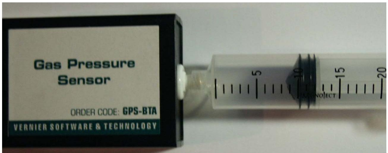
Die Luft in einer Spritze wird langsam komprimiert. Dabei liefert ein Gasdrucksensor den aktuellen **Gasdruck p** in der **Einheit kPa**, die Größe des **Volumens V** wird an der Spritze (Gesamtvolumen ist 20 ml = 20 cm<sup>3</sup>) eingestellt und manuell dem Messprogramm eingegeben. Mache eine Online-Messung. Die Messdaten werden in einem p-V-Diagramm dargestellt und analysiert.
