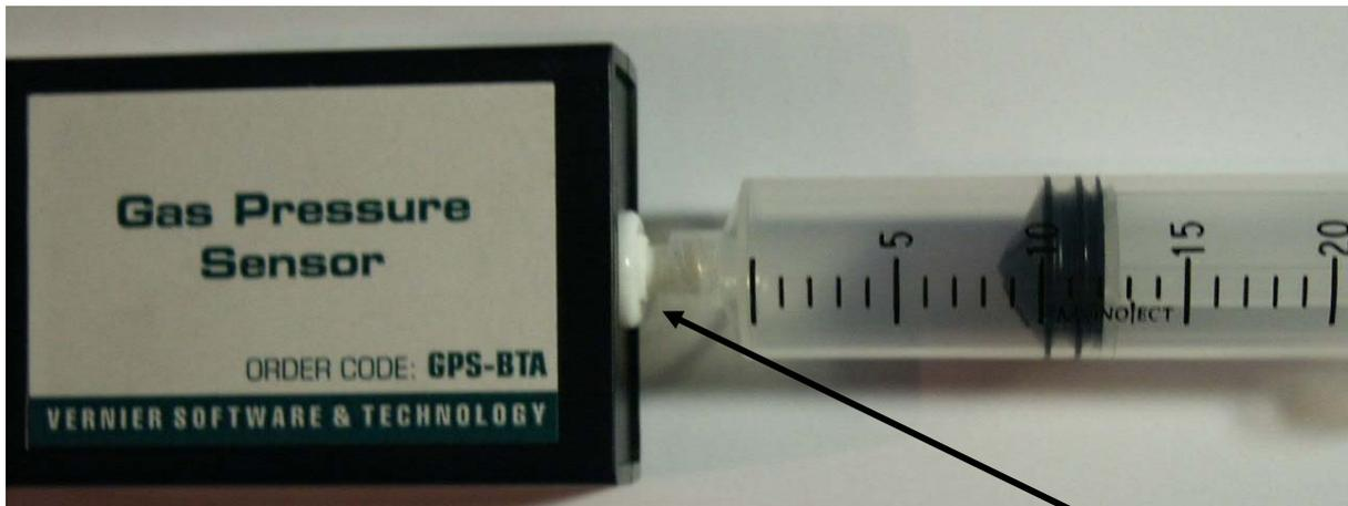
Es ist am Bild ersichtlich, dass die Spritze, in der Luft komprimiert wird, **direkt** auf den Gasdrucksensor mit **Gefühl** (!! damit das Gewinde nicht kaputt wird) aufgeschraubt wird.
