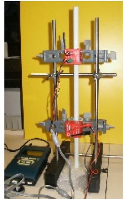
Die linken beiden Spannungstöße entstehen in der oberen Spule, die rechten zwei in der unteren Spule.
