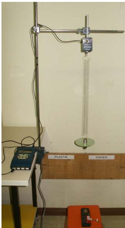
An einer Feder hängt ein Masse (z.B.50g + 50g), die in Schwingung versetzt wird; **von unten** wird die Bewegung mit dem **Ultraschall-Detektor** aufgezeichnet. Damit der Sensor das kleine Massenstück trifft, hängen wir auch noch eine CD (z.B. an das Massenstück geklebt) oder einen kreisrunden Karton dazu.
