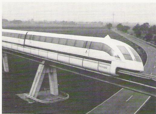
Bild 4-110. Magnetschwebbahn Transrapid auf der Versuchsstrecke.
